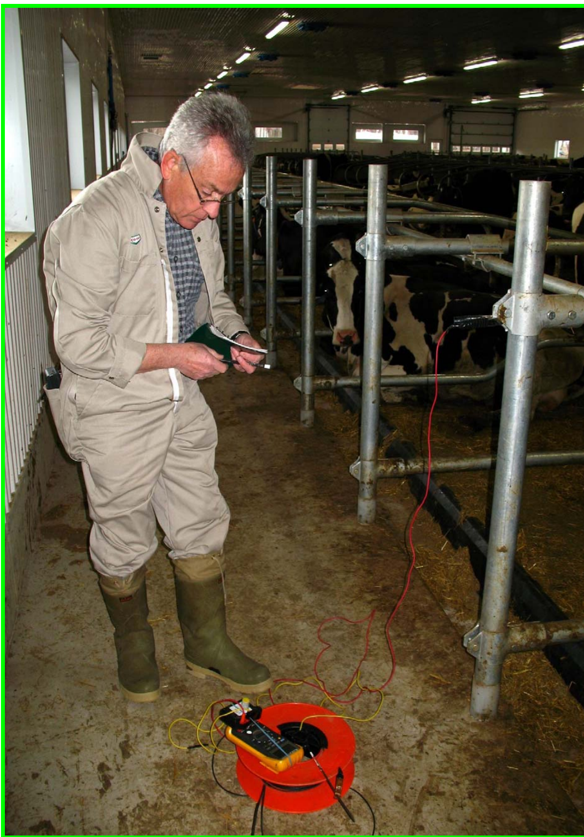
Vérification de la présence de tensions dans la tubulure métallique
