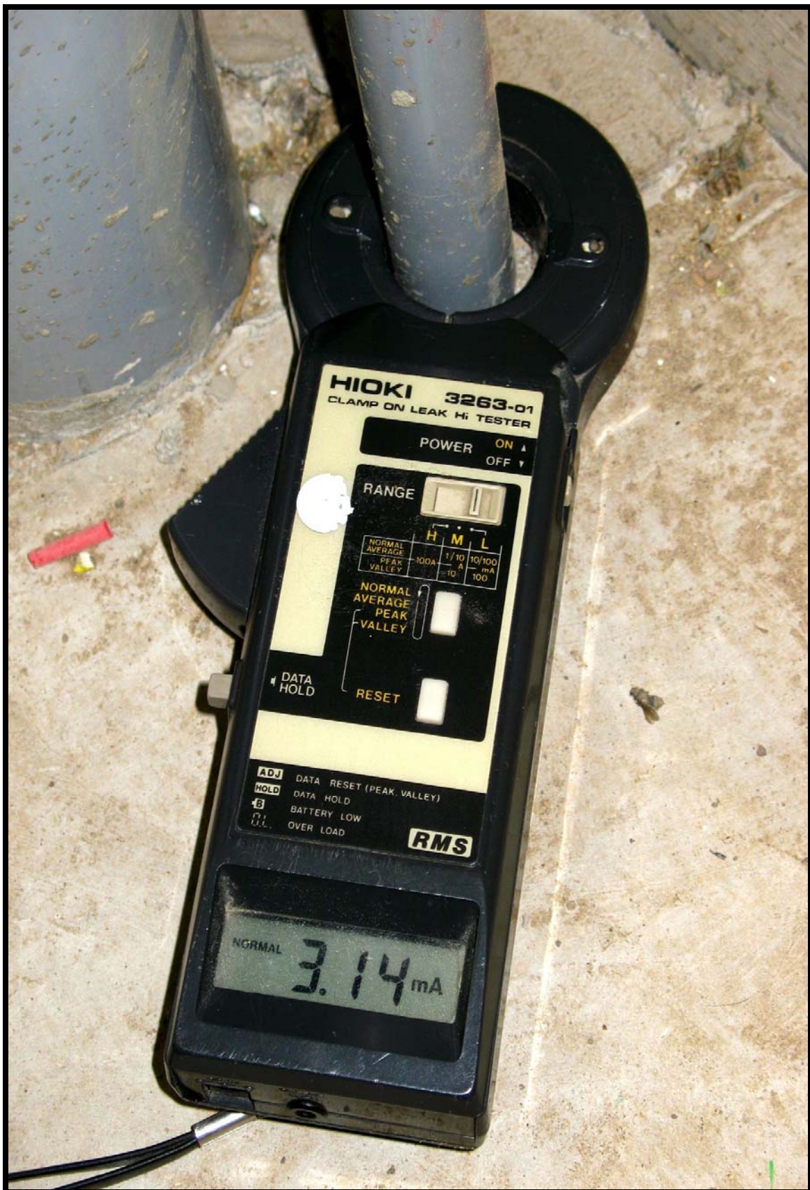
Observation d'un courant de 3 milliampères à l'entrée électrique
